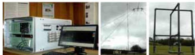
Figuur 43: De Digisonde-4D (links), de zendantenne (midden) en ontvangstantenne (rechts).
