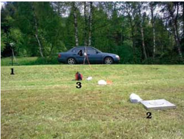
Figuur 9: Opstelling van de apparatuur, met (1) een hogesnelheidscamera, (2) een instrument om het elektrisch veld te meten, (3) een generator voor het opwekken van elektriciteit, en (4) een GPS.
