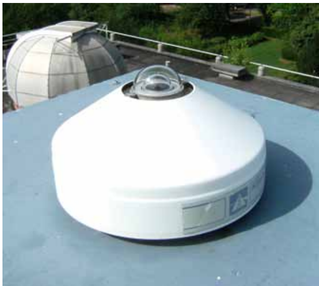
Figuur 37: Pyranometer die gebruikt wordt om de globale zonnestraling in Ukkel te meten.
