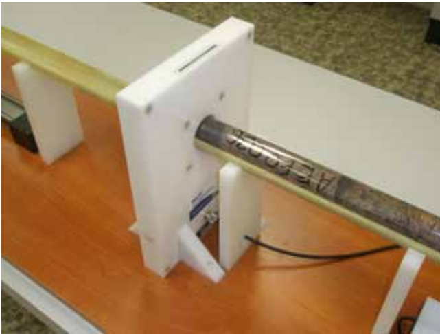
Figuur 33: Ringvormige sensor in het midden van de houder en het te meten monster.
